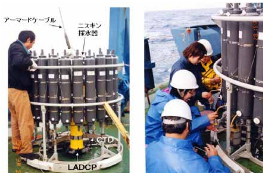
図 1：ロゼット採水システム（左）と船上での採水作業（右）
