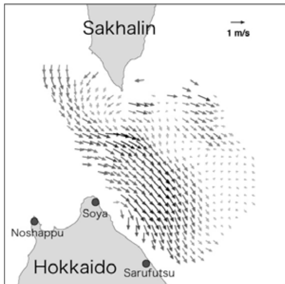
図5: 海洋HFレーダによる表層流の観測例: 空間分解能約3kmで表層流速が得られる。2003年8月17日20時の例。Ebuchi et al.(2006)より加筆。毎時のリアルタイムデータは、 http://www.woc.lowtem.hokudai.ac.jp/hf-radar/index.html にて公開されている。
