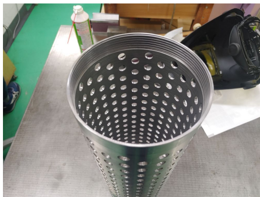
図 10 本体部のネジ加工。
