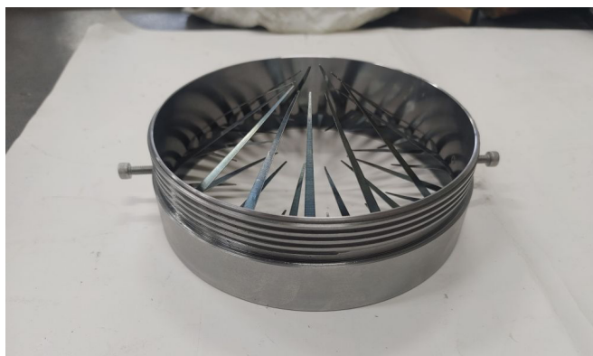
図 9 キャッチャーリングにバネ材を取り付けた様子。本体部取り付けのためのネジ加工もされている。
