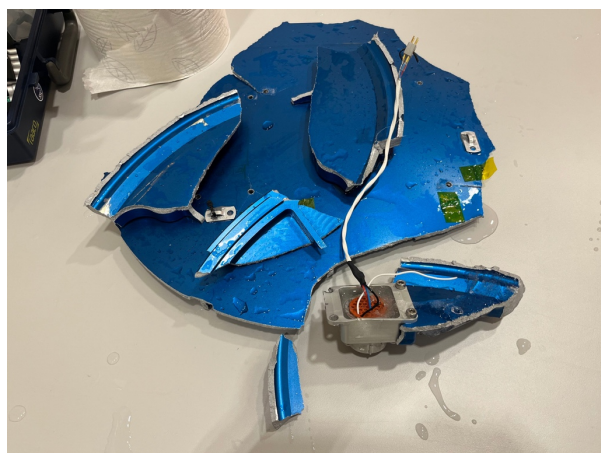
図 16 帰還時に湖の氷に衝突して損傷したペイロードの下部。
