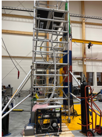
図 7 観測ロケットの横に設置した真空排気装置（手前下）。ロケットと装置間は NW16 のフレキシブルチューブでつながっており、電気的には絶縁されている。我々 DUST のペイロードは、ノーズコーンの下のシルバーの場所である。
