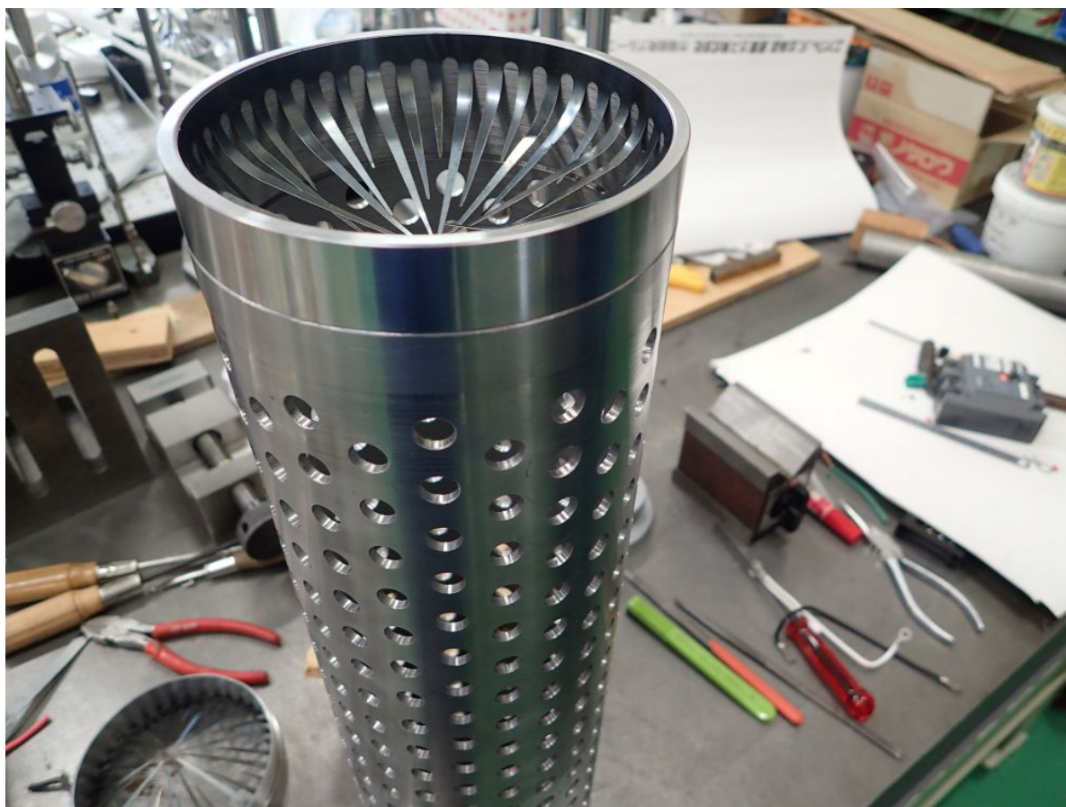
図 11 本体部とキャッチ部の接続した様子。
