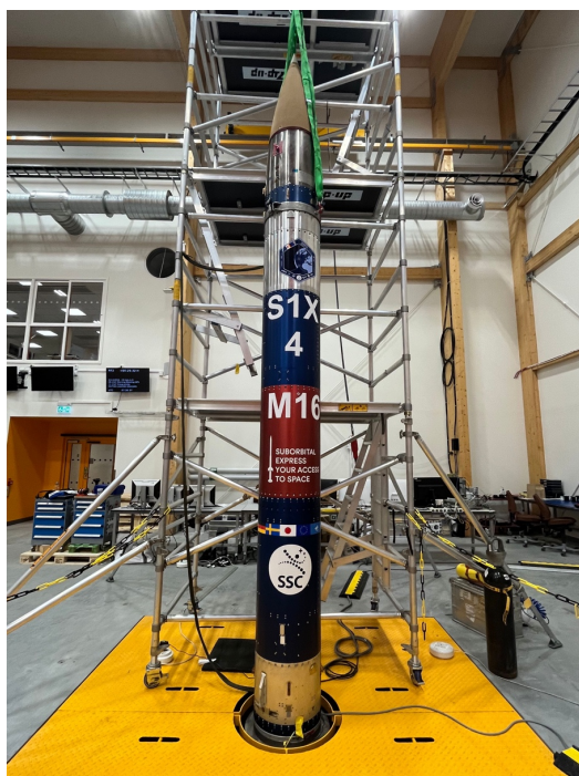
図 10 準備を終えた観測ロケット。我々のペイロードはノーズコーンの下の最初の小さな青色のモジュールの下から、SIX4 と書かれた青色のモジュールの上までのシルバーの領域。
