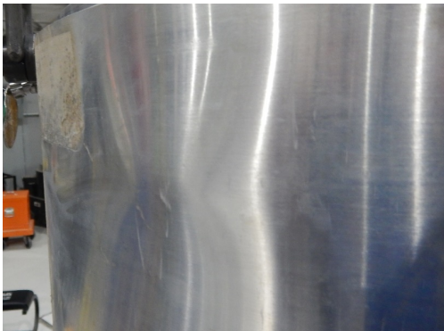
図 13 回収後のペイロード部の外筒の拡大写真。外壁が凹んでいる。
