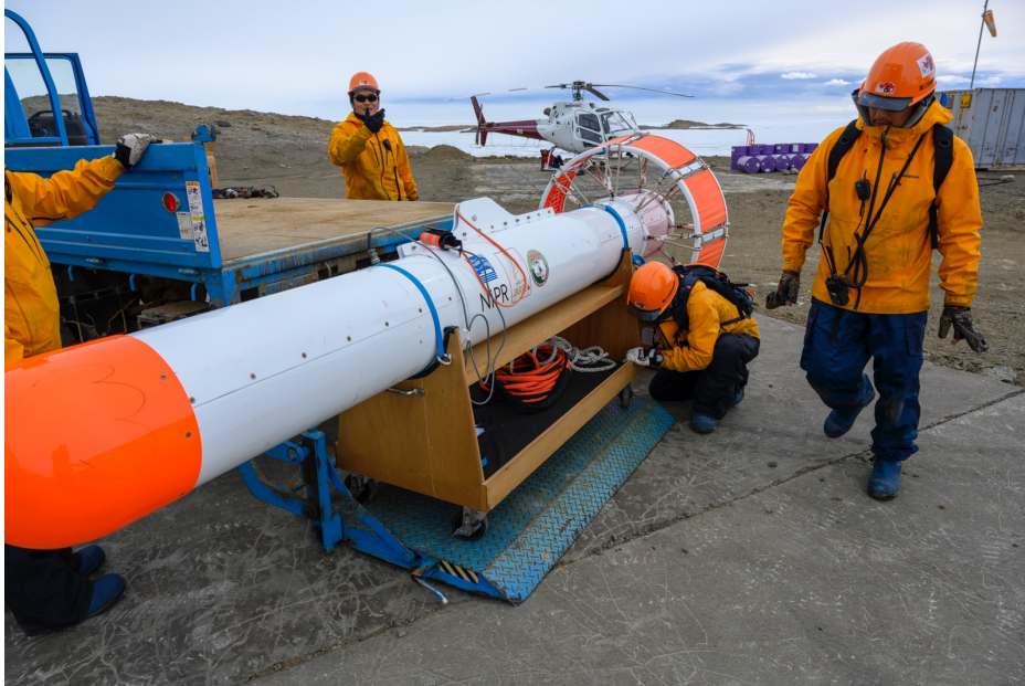
図 10 EM-bird 本体。奥のヘリコプターでスリング（吊り下げ）して、広範囲に渡る氷厚データ（積雪と氷の厚さを合わせた値）を取得することができる。離発着時、下で測器を支える人は、ヘリコプターの風を直接受けるため、非常に大変。
