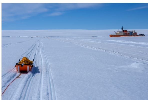
図 8 北の浦で観測中のソリ搭載型の氷厚センサー（左）。スノーモービルに括り付けて、けん引する。昭和基地と接岸中の「しらせ」間の移動にもスノーモービルを利用した。
