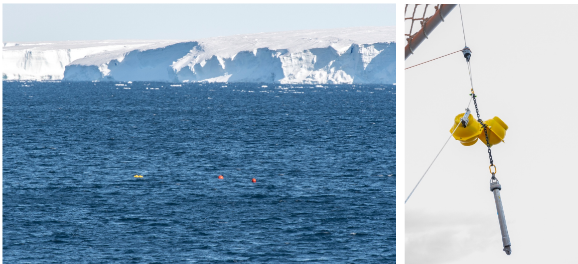
図5 左: 係留系が浮上してきた時の様子。浮いているフロート間のロープに四爪(スマル)を投げ入れ引っ掛けて回収する。右: 回収時の切離装置とガラスフロート。クレーンで吊り上げて回収する(たまに人力で回収する時もある)。切離装置より下にある重りが切り離されて浮上してくる。
