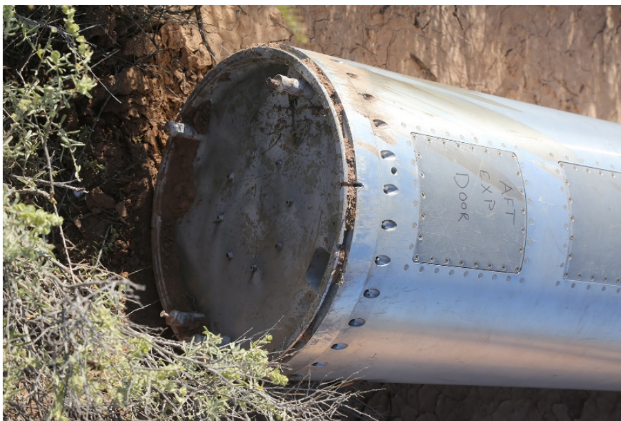
図 11 打ち上げ後のペイロード下部。アルミダンパーが完全に消失している。
