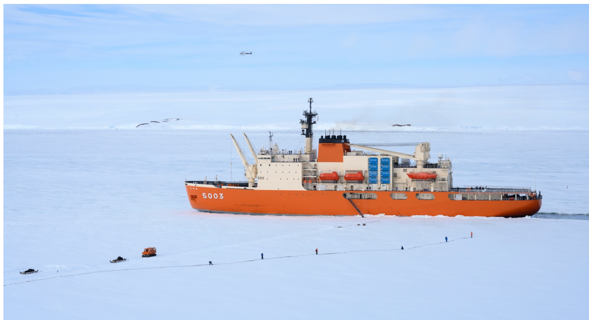
図 1 昭和基地沖に接岸直後の「しらせ」。左下から延びている線は、「しらせ」から昭和基地の燃料タンクまで繋げる燃料パイプ。この「しらせ」が停留している短期間一度の燃料補給で、昭和基地の発電機などを一年間動かし続けられる十分量を送る。
