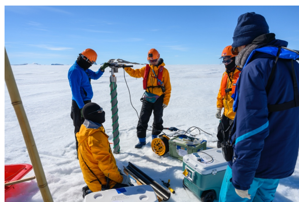
図 9 アイスオーガーを用いた、海水コア採取の風景。採取したコアは温度を測定し、「しらせ」の冷凍庫に運び、最終的には日本まで輸送し、分析する。
