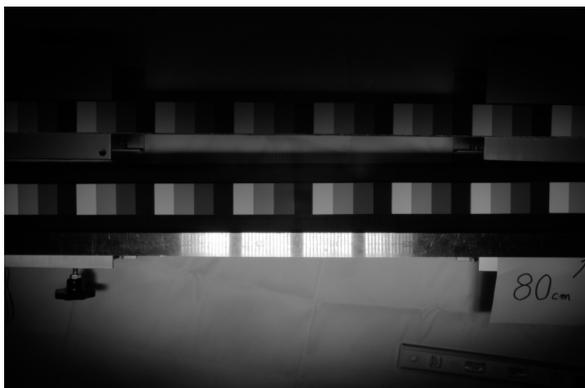
図 1 標準校正板の近赤外反射写真。それぞれ明るい板から 92、50、20、5% の反射率を示す。絞り 25、シャッター速度 1/40 秒、焦点距離 28 mm。
