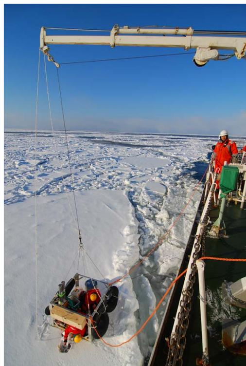
図2 バスケットを用いた海氷サンプリング。
