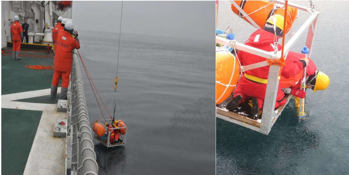
図 5 フラジルアイスのサンプリングの様子。バスケットを海面直上で宙吊りにして特製シリンダーでグリーンアイスを直接採取。
