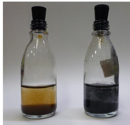
図3 硫黄不均化細菌の培養(左が培養前、右が培養後)。チオ硫酸の不均化によって生成した硫化水素が酸化鉄と反応して黒く変色する。
