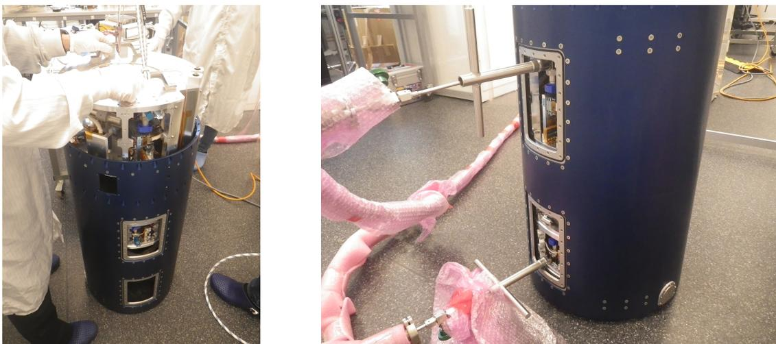
図5 SSCにおいてクリーンブース内でペイロードを外筒に組み込む様子(左)と外筒に用意したハッチから真空引きする様子(右)。
