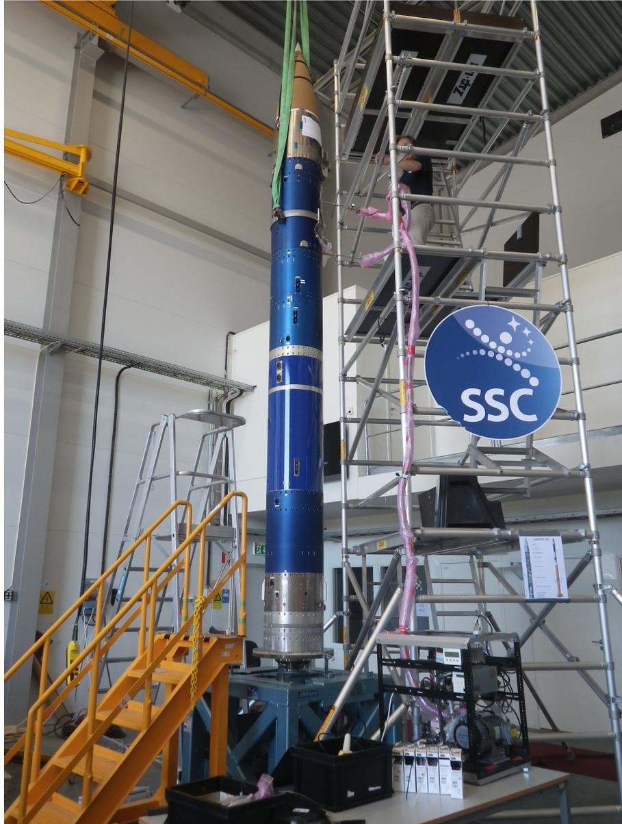
図 6 エスレンジのドーム内で準備中の観測ロケットのペイロード部。机の上に設置されているのが真空排気装置。NW25 のフレキシブルチューブを上方に伸ばして、外筒に用意したハッチから 2 台の核生成チェンバーを同時に真空引きしている。
