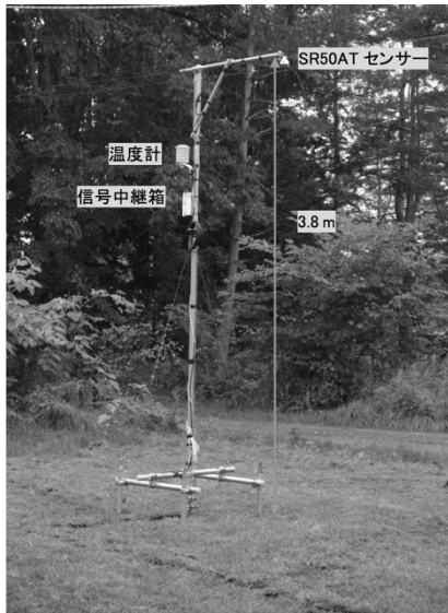
図 8 支柱に取り付けられた SR50AT のセンサー、 温度計、信号中継箱
