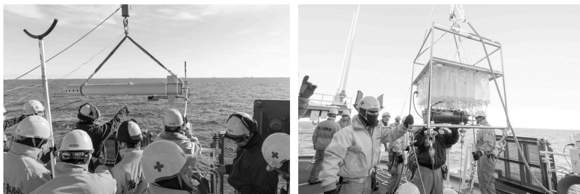
図 10 ケープダンレー沖に投入した係留系。(左)浮沈型係留ブイ付係留系 (2/26 5:54 (UTC) 投入)、(右) 時系列自動採水器付係留系 (2/28 4:02 (UTC) 投入)。
