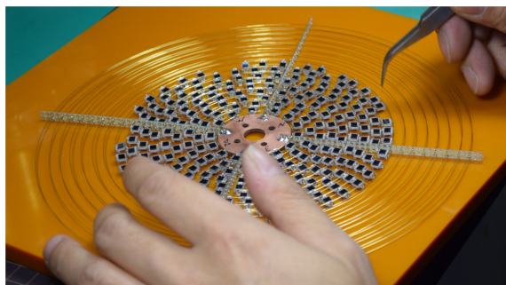
図1 ダイオードツリーの1層にフォトダイオードを配置する様子。
