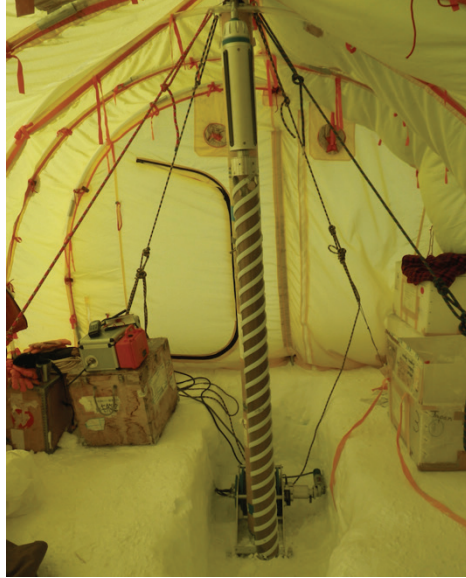
図 2 使用した掘削機。
