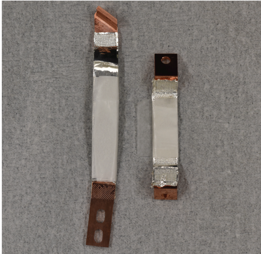
図 2 改良型ヒートコンダクター。銅製の留め具には 6N グレードの超高純度銅を使用。 銀箔束と銅製の留め具は超音波溶接によって接続した。
