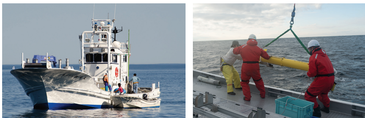
図 1 係留システム設置回収に利用した船舶と現場海域でのブイ設置作業風景。
