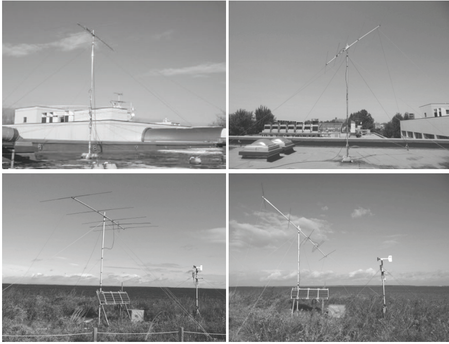
図5 札幌マスター局（上段）、キムアネツプ・リモート局（下段）のアンテナ部。 左（右）はアンテナの向きを水平（仰角45度）にしたもの。
