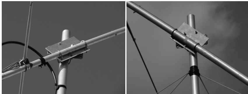
図6 アンテナ仰角を45度にするための固定用留め具。
