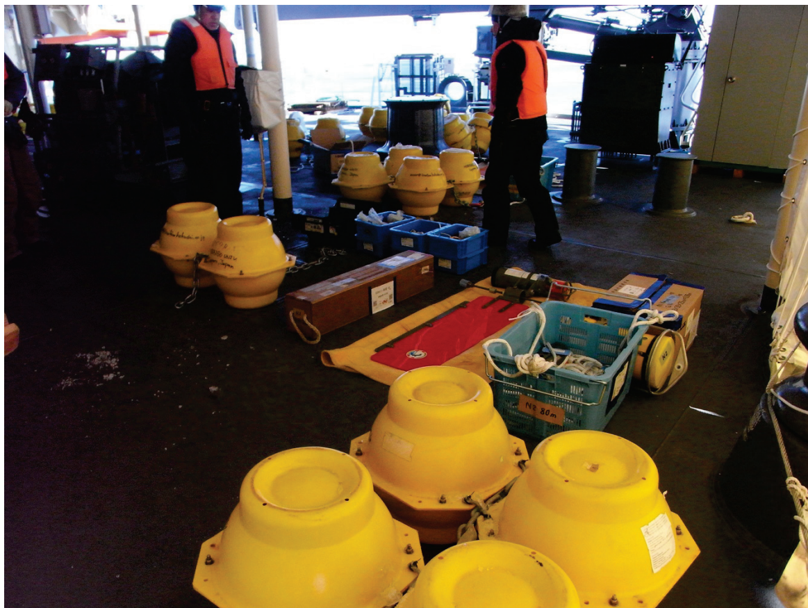
図4 投入前の係留系。他の観測点のものも、観測甲板で出来る限りつないでおいだ。
