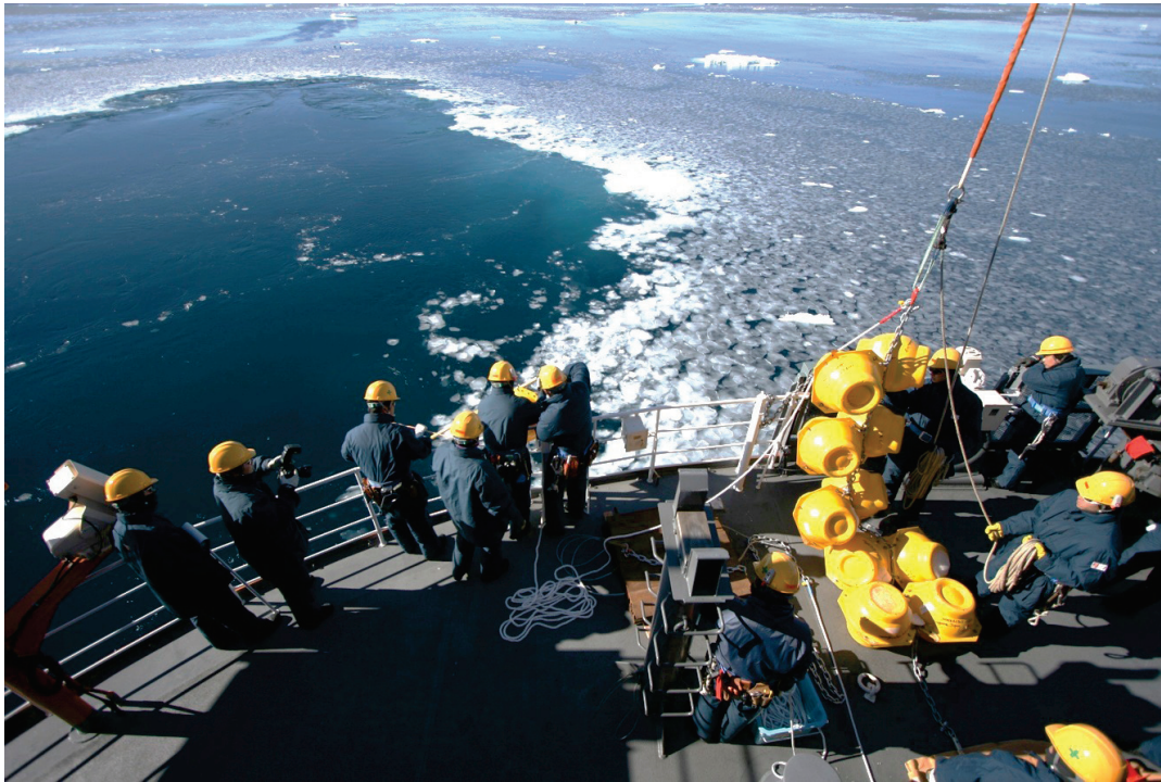
図 5 係留系の設置風景。新生氷が一面に広がっている観測点もあった。
