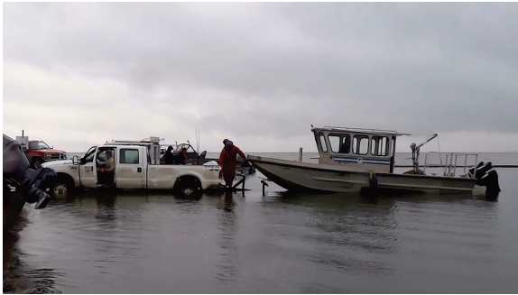
図 3 係留系の回収・設置に使用したボート。 後ろのデッキにはウィンチが付いている。
