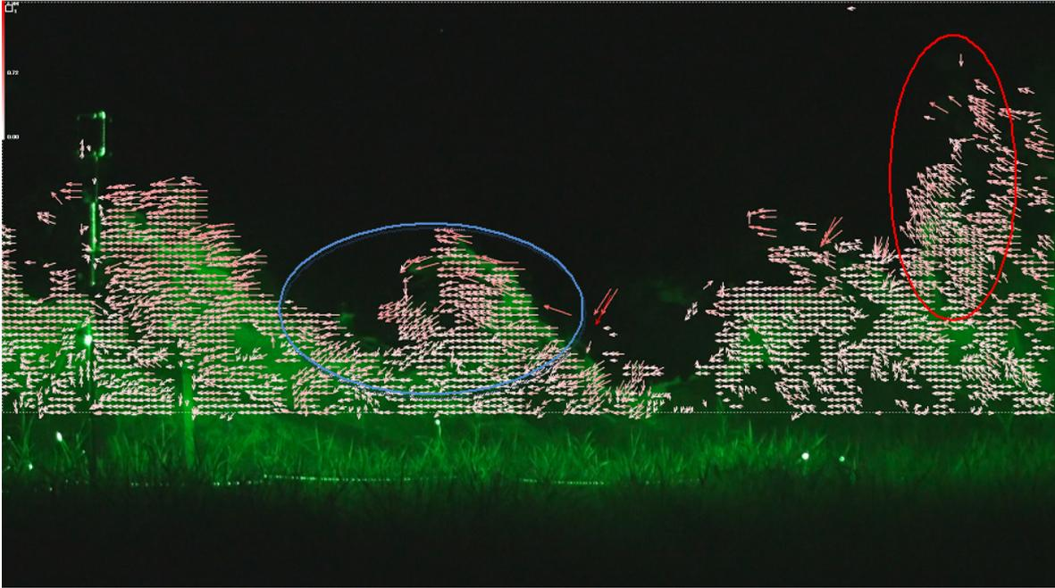
図 4. 撮影された画像と PIV 解析によるベクトル算出図。主風向は右から左、画像範囲は  $4.5 \text{ m} \times 3.1 \text{ m}$ 。青丸は水平風速の速い下降流、赤丸は水平風速の遅い上昇流を示している。
