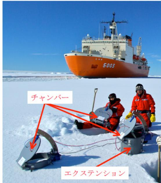
図 2. 南極海定着氷上での自動開閉式 CO<sub>2</sub> チャンバー使用風景
