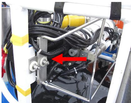
図 3 急きょ作成した CTD とフレームを固定するためのステイ
