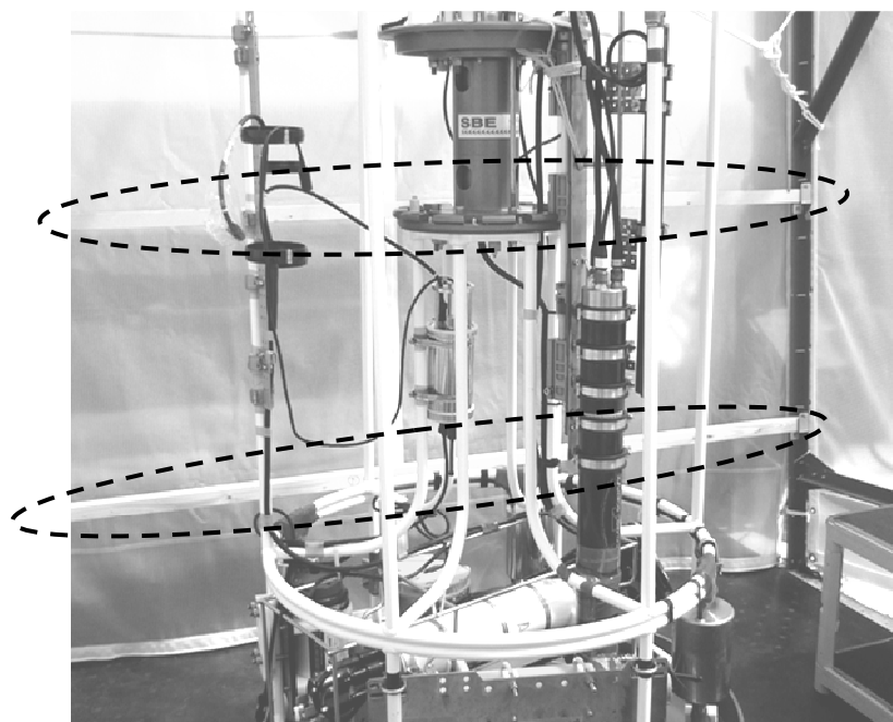
図 2 テント内写真。右舷側からの風を緩和するために木の棒（点線部分）を二本設置で きるフックを取り付けた。
