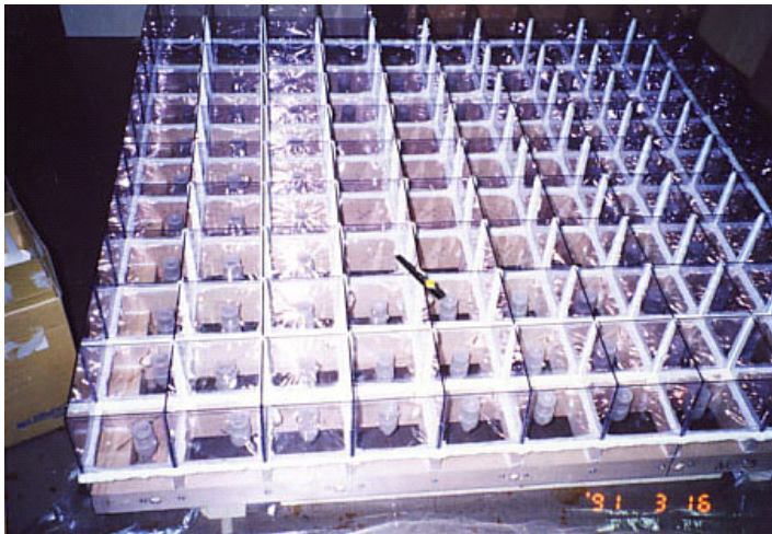
図 6. マルチ・コンパートメント型ライシメーター
