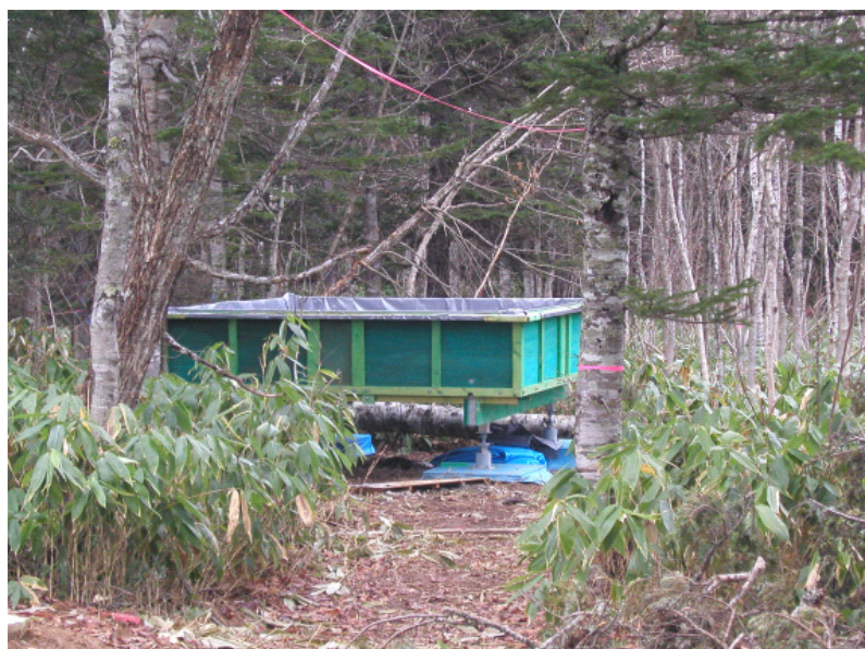
図 10. 大型の秤量型ライシメーター
