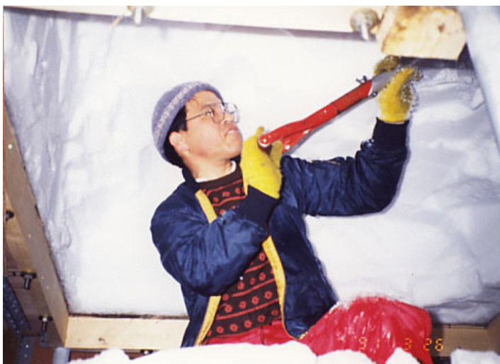
図 7. 地下壕の中から積雪底面を薄く削っているようす
