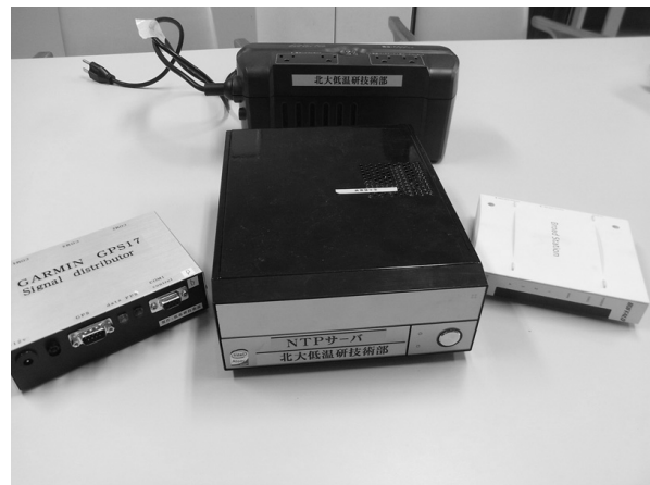
図 4. 船内で使用するハードウェア一式。 前列左から GPS 信号 4 分配器(富士ら 2009 を参照)、NTP サーバ用 PC、ブロードバンドルータ。後列は UPS)。
