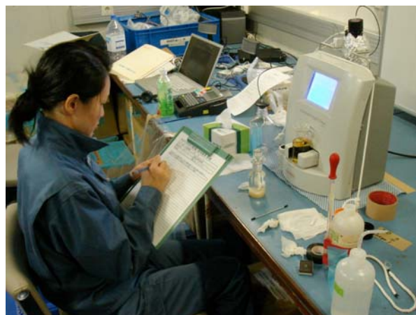
図3 (左) : Kh06 の溶存酸素滴定装置。印字された値を PC に一つ一つ入力した。(右) : Kh07 の溶存酸素滴定装置。内蔵されたコンパクトフラッシュに滴定値などのデータが保存されるが、念のために野帳にも記入した。
