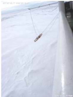
図 19 船が氷海運航中のときの EM-31 と氷状
