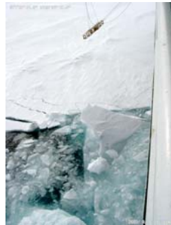
図 19 船が氷海運航中のときの EM-31 と氷状
