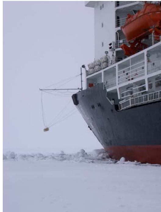
図4 チュクチ海における砕氷船「雪龍」に搭載した SEM (Ship-borne EM) による観測
