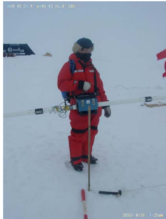
図2 チュクチ海の GEM (Ground-based EM) による観測
