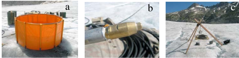
図2 掘削システムの各部位 a. 貯水槽、b. ドリル先端部、c. 三脚と滑車
