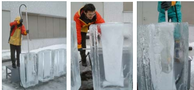
図4 氷塊(1×0.5×0.25 m 3 )を用いた掘削試験
