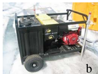
図 1 a. 熱水ドリル掘削システム概要図、b. ポンプ・ヒーター
