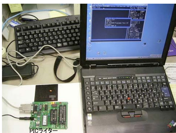
図 4 PC から PIC 専用ライターを使っての書き込みを行っている様子
