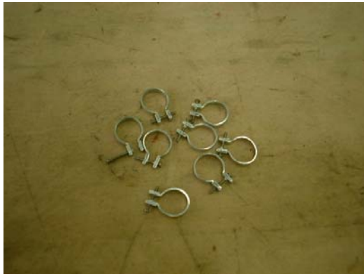
図9 パイプ固定バンド完成品
