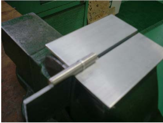
図7 パイプ固定バンドの形作り
