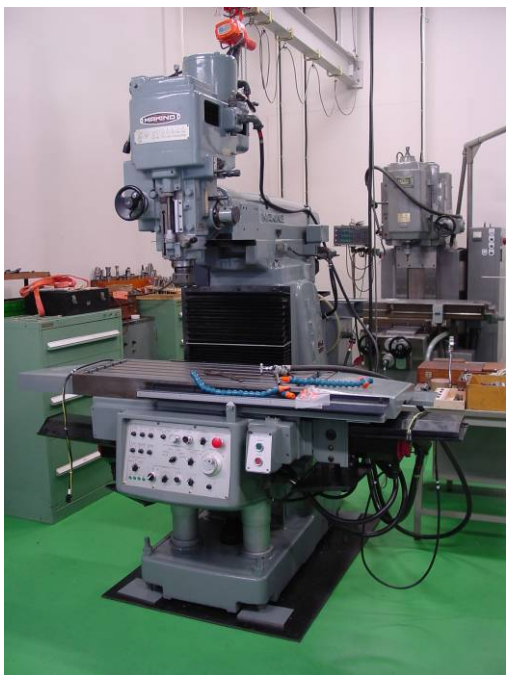
図 1 レトロフィットした後の NC フライス盤
