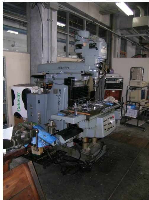
図 2 レトロフィットする前の NC フライス盤
