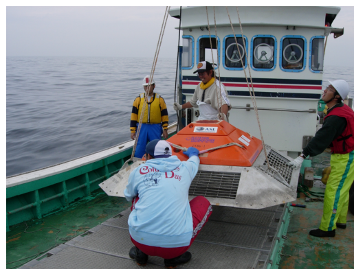
図 2: 漁船による海底マウントの設置作業。
