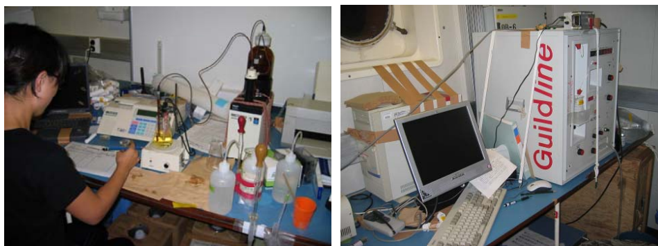
図2 船上での溶存酸素 (左) および塩分測定用オートサルの様子 (右)
