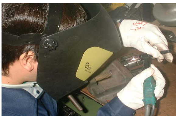
溶加棒を用いないT I G溶接
