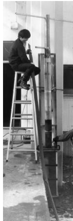
日本初の液封掘削実験
