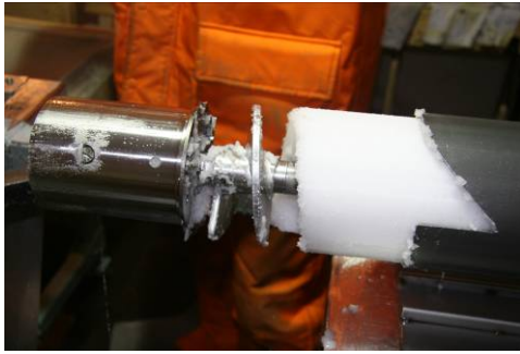
日本独特な削りくず回収部
