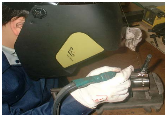
溶加棒を用いたときのT I G溶接
