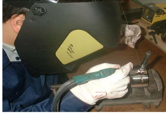
溶加棒を用いたときのT I G溶接
