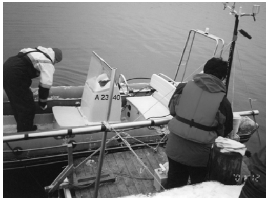
(3) フロートに観測システムを設置 日射計、照度計、ソーラーパネルを同じ方向に 向けて固定する
