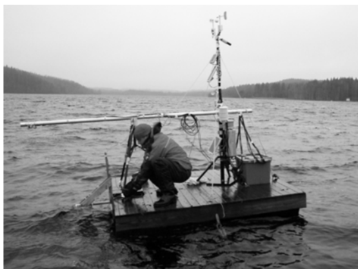
(5) プラットホームの固定 ソーラーパネルを南に向けて、4個のアンカーを落す アンカーのロープを調整しながらプラットホームが回転 しないように固定する
