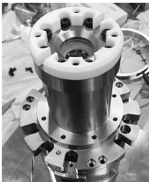
南極で使用するボアホールカメラ（掘削孔底撮影装置）と、掘削孔底の氷片回収装置
