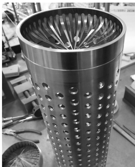
南極で使用するボアホールカメラ（掘削孔底撮影装置）と、掘削孔底の氷片回収装置
