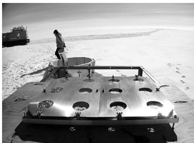
南極ドームふじ基地における試薬実験装置（シャーレを固定する台）
