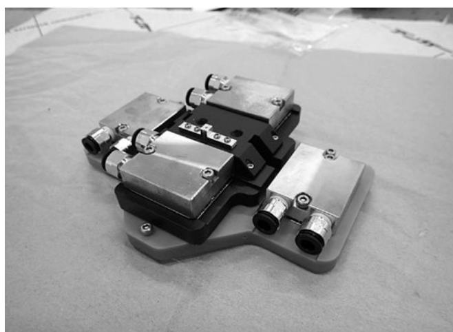
水・氷界面観察用上下温度勾配チャンバー（倒立型の液相チャンバー）
