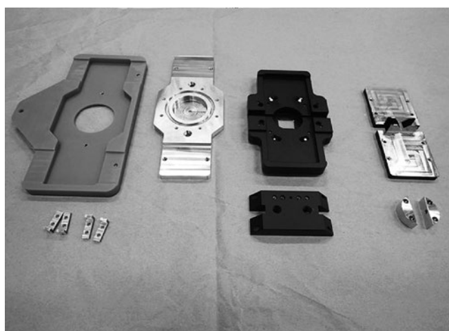
水・氷界面観察用上下温度勾配チャンバー（倒立型の液相チャンバー）
