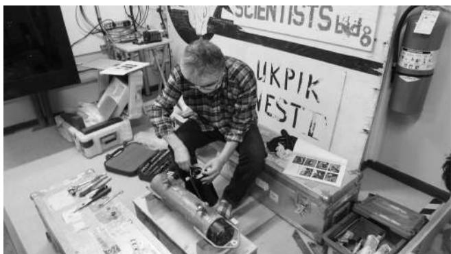
係留系観測機器の撤収手続・作業
