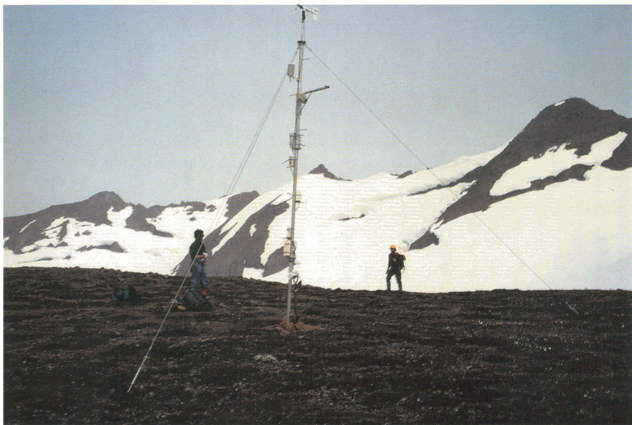
クロノツキー半島カレイタ氷河に設置した無人氣象観測器（1996 年 7 月）
