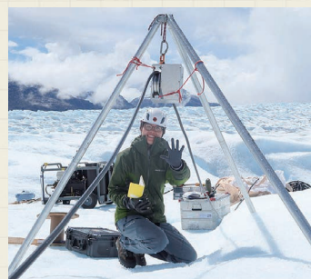
図4. 熱水を使って氷河を掘削
