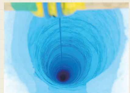
図5. 氷河底面につながる450メートルの掘削孔
