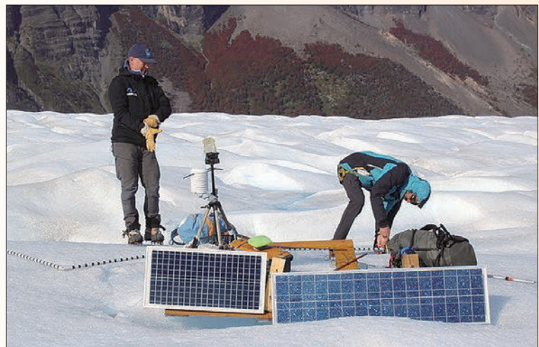
写真 1. 2020 年 9 月より GPS による高精度氷河流動観測を開始した。
