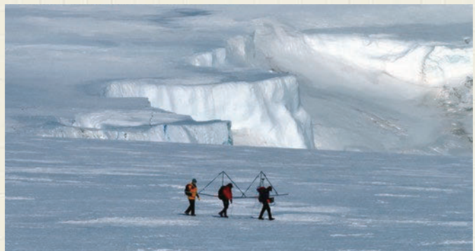
スカルブスネス地域での氷レーダーによる氷床基盤地形測量（撮影：水野潤）
