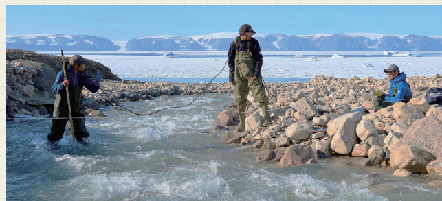
図2. 氷河流出河川での流量測定。
