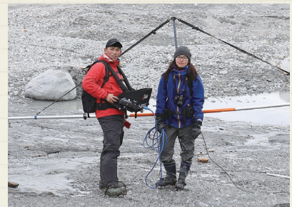
図2. 氷レーダーによって氷河の厚さを測定。
