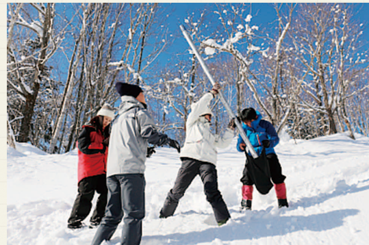
図2 スノーサンブラーを使って森林内の積雪量を測定。
