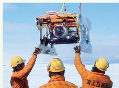
図7 氷海に投入されるROV（撮影：矢口春吾）
