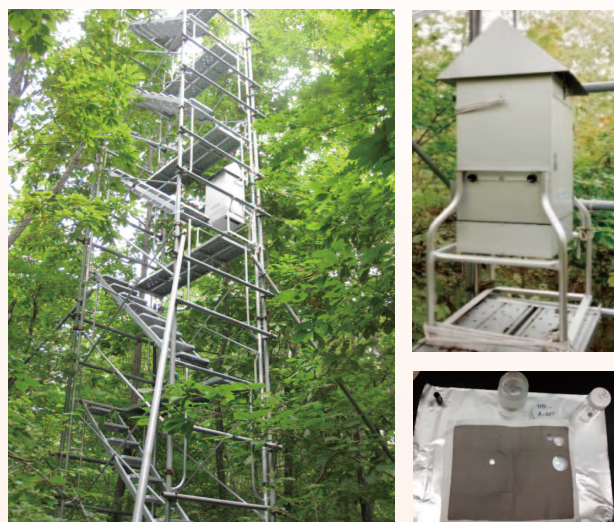
図2: 苫小牧研究林の観測タワー（左図）、設置された大気エアロゾル捕集装置（右上図）および石英繊維フィルター上に捕集し茶褐色に着色した大気エアロゾル試料（右下図）。
