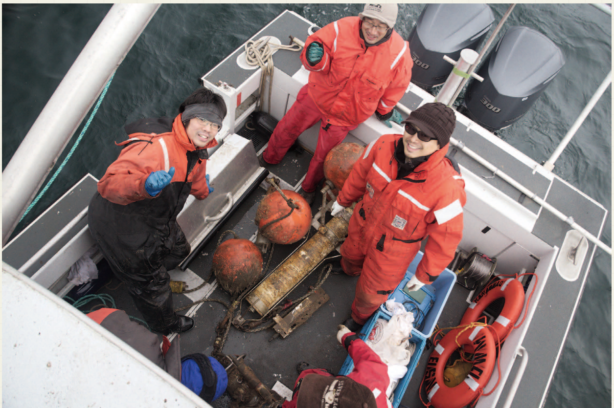
小型ボートにて、氷厚計や流速プロファイラーの回収に成功した直後
