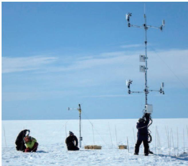
写真1：グリーンランド氷床に設置した自動気象観測装置
