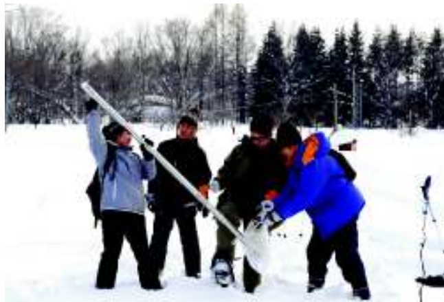
母子里積雪実習におけるスノーサンプラーを使った積雪観測
