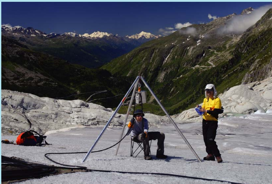
スイス・ローヌ氷河での熱水掘削風景。 掘削を行っているのは北大環境科学院の大学院生津滝俊君と、 スイス・ベルン大学の大学院生 Flavio Lehner 君。 撮影は2008年 7月
