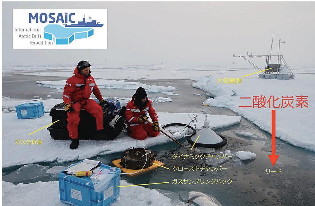
図4: 中央北極海でのMOSAiC時に実施したフローティングチャンバーによるリード—大気間CO<sub>2</sub>交換測定の様子。アメリカ・ボルダークのグループが持ち込んだダイナミックチャンバー（外部からチャンバー内に空気を取り入れ、外部とチャンバー内のCO<sub>2</sub>濃度差より交換量を評価する方法）と著者が持ち込んだクローズドチャンバー（閉鎖型：説明は本文参照）の比較実験を実施した。リードの水のCO<sub>2</sub>濃度は大気に対して低く、大気からCO<sub>2</sub>を吸収する結果が得られた。著者による撮影。
