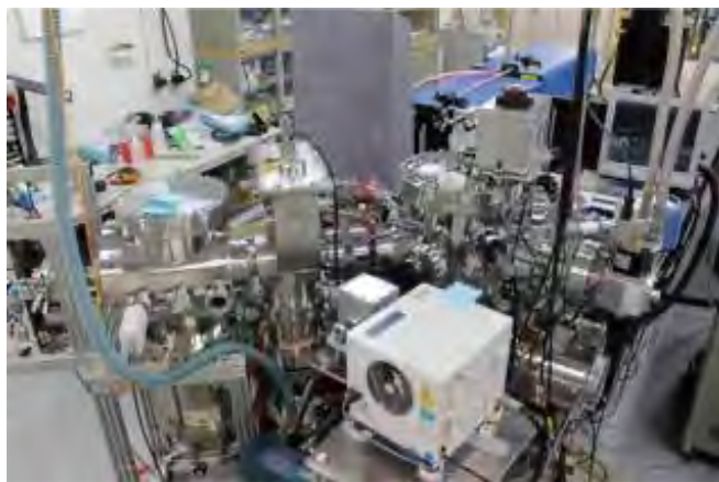
超高真空実験装置。装置内で宇宙環境(超高真空、 -273^{\circ}\text{C} の極低温)にある微粒子表面を再現し、そこでの原子や分子の振る舞いを調べる。 An ultra-high vacuum chamber where atomic and molecular processes occurring in space are reproduced.
