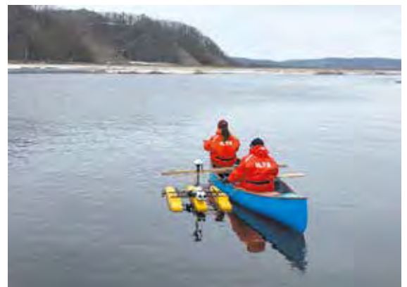
ドップラー式超音波流向流速計を使用した河川流量観測 Survey of East Hokkaido rivers by using Acoustic Doppler Current Profiler
