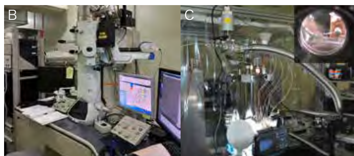
B. ナノスケールで液体や氷を可視化できるフルイド反応透過電子顕微鏡。 A transmission electron microscope capable of visualizing liquids and ice at the nanoscale.
