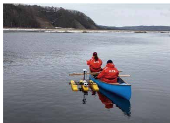
ドップラー式超音波流向流速計を使用した河川流量観測 Survey of East Hokkaido rivers by using Acoustic Doppler Current Profiler
