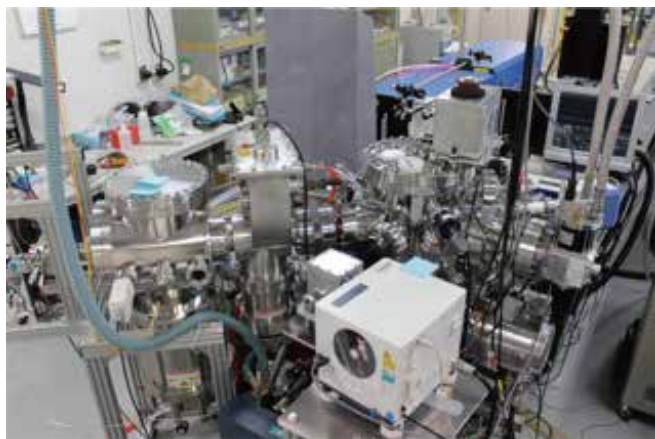
超高真空実験装置。装置内で宇宙環境(超高真空、-273℃の極低温)にある微粒子表面を再現し、そこでの原子や分子の振る舞いを調べる。 An ultra-high vacuum chamber where atomic and molecular processes occurring in space are reproduced.
