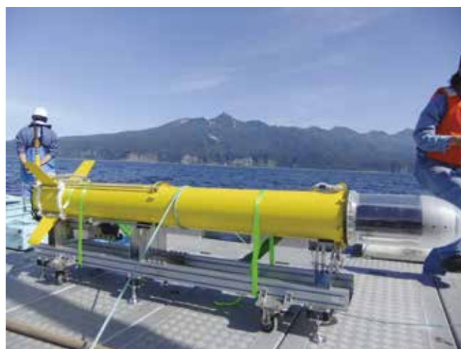
開発中のリアルタイム海洋観測ブイシステムの知床沖試験 Field experiment of a real-time ocean observing buoy system off Shiretoko
