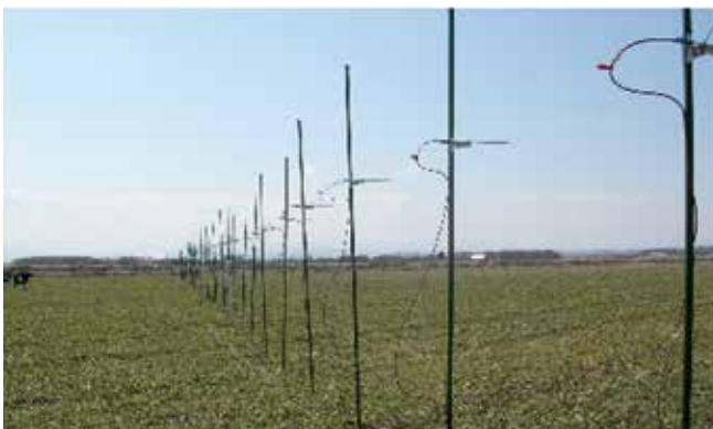
直線上に配置した測器列による乱流空間構造の観測 Field observation of turbulence structure in the near-surface layer
