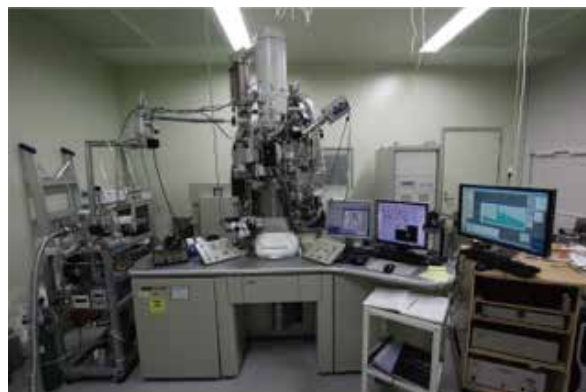
超高真空極低温透過型電子顕微鏡。装置内で氷を作製し、その組織・構造を観察する。 Ultra-high vacuum low temperature transmission electron microscope for the in-situ observation of ices.
