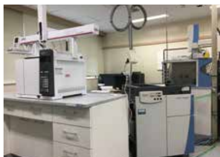
ガスクロマトグラフ-同位体比質量分析装置 Gas chromatograph-isotope ratio mass spectrometer
