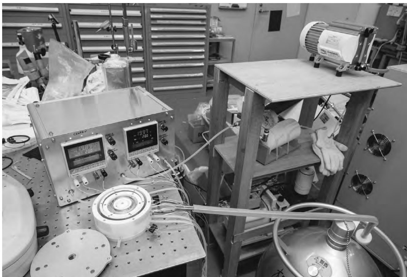
-100 °C氷成長チャンバー及び液体窒素供給装置
