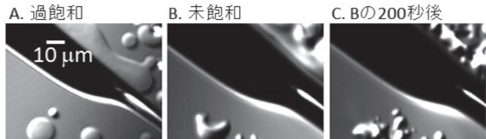
塩酸ガス存在下、氷六角底面上に生成する擬似液体層：水蒸気は過飽和（A）、未飽和（B）、B撮影の200秒後（C）。
