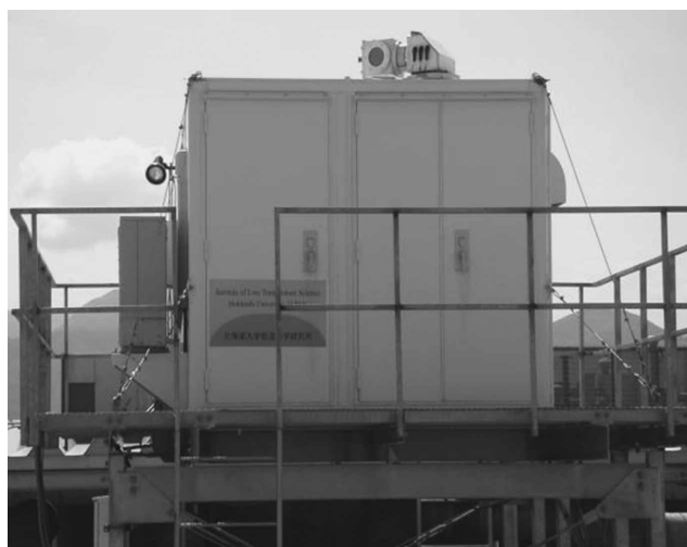
1 コヒーレントドップラーライダーシステム
