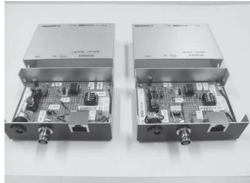
ASTE望遠鏡用受信信号変換器
