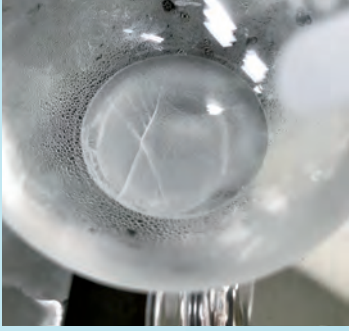
真空ポンプで凍ったフラスコの中の水
